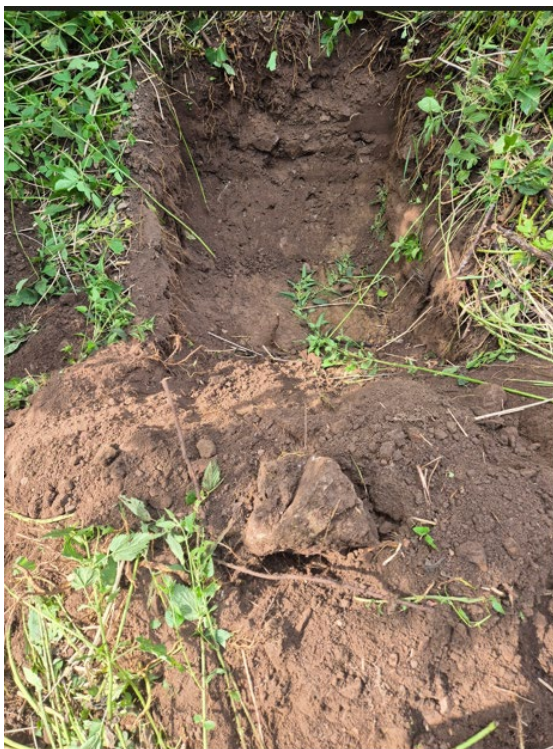
P 9. Mulljord med inslag av enstaka stenar. Djup ca 1 m.
