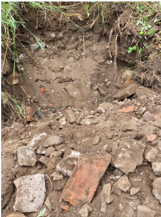
P21 Mulljord med inslag av sten och en större andel tegel och betong. Djup ca 1 m.
