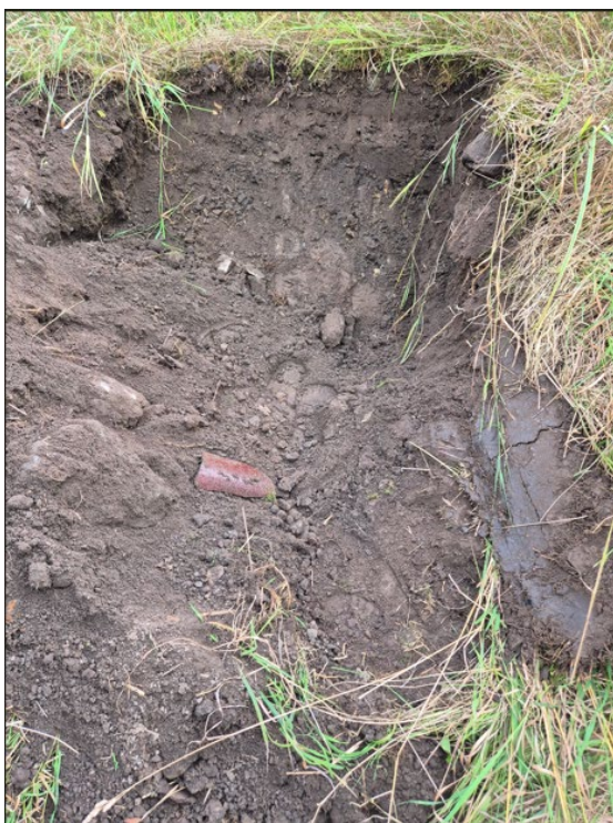
P12. Mulljord med inslag av lera och något stenig. Bit av keramiskt rör. Djup ca 1 m.
