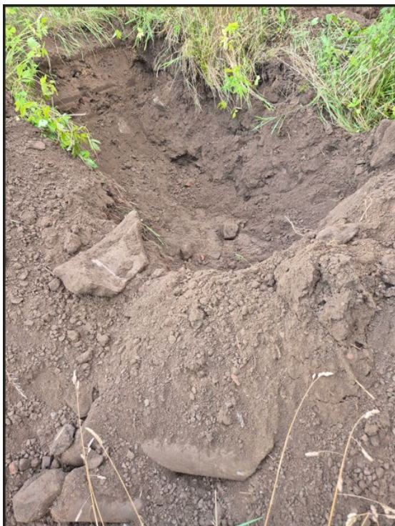
P 5. Mulljord med inslag av sten och med enstaka betongstycken och tegel. Djup ca 0,75 m
