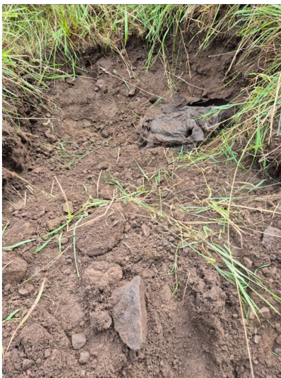
P10 Mulljord med steninslag och någon betong samt plastrester och några bitar asfalt. Djup ca 1 m.
